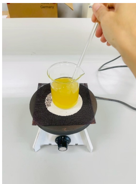
ภาพ 18 วิธีการละลายอาหารเลี้ยงเชื้อ Nutrient Agar; NA บนเตาต้มร้อน
