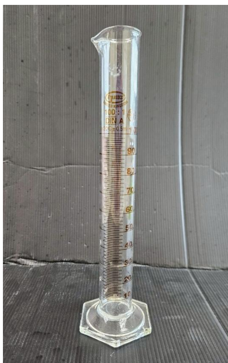
ภาพ 6 กระบอกตวง ขนาด 100 มิลลิลิตร (Cylinder)
