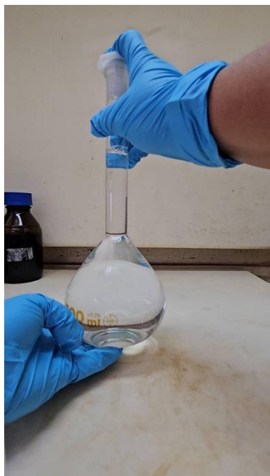
ภาพ 22 วิธีการปิดจุกขวดวัดปริมาตรและวิธีการทำให้สารละลายเป็นเนื้อเดียวกัน
