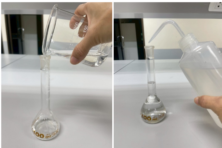
ภาพ 25 วิธีการปรับปริมาตรสารละลาย Shear's mounting agent
