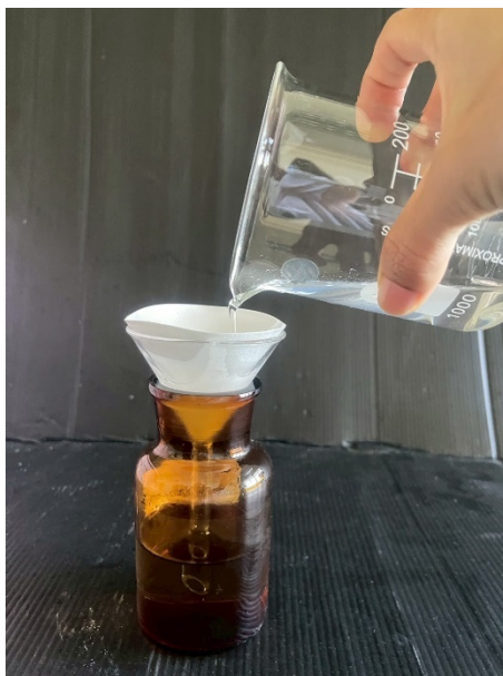
ภาพ 26 วิธีการกรองสารละลาย Shear's mounting agent
