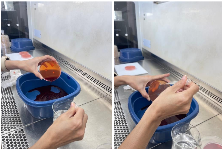
ภาพ 38 วิธีการล้างสารละลายคองโกเรดด้วยสารละลาย 1M NaCl
