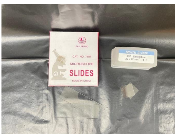
ภาพ 4 แผ่นสไลด์ (Slide) และกระจกปิดสไลด์ (Cover glass)
