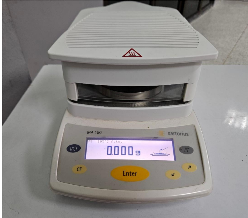
ภาพ 6 เครื่องวิเคราะห์ความชื้น (Moisture balance) รุ่น MA150 ยี่ห้อ Sartorius
