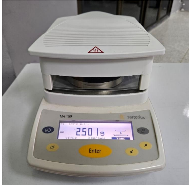
ภาพ 22 วิธีการปิดฝาเครื่องวิเคราะห์ความชื้น
