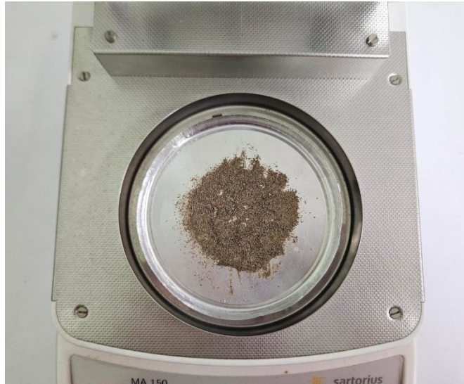
ภาพ 16 ลักษณะการวางตัวอย่างดินในงานอลูมิเนียม
