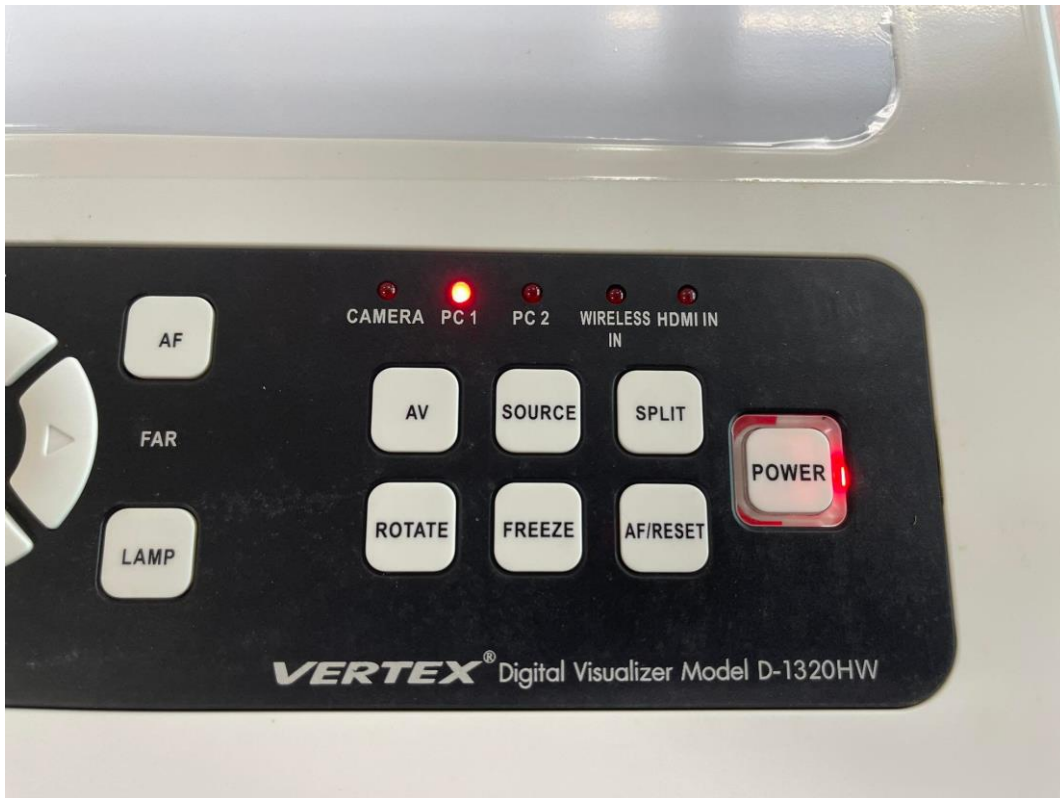
ภาพ 8 กดปุ่ม POWER ที่ เครื่อง Visualizer ให้เป็น ไฟสีแดง
