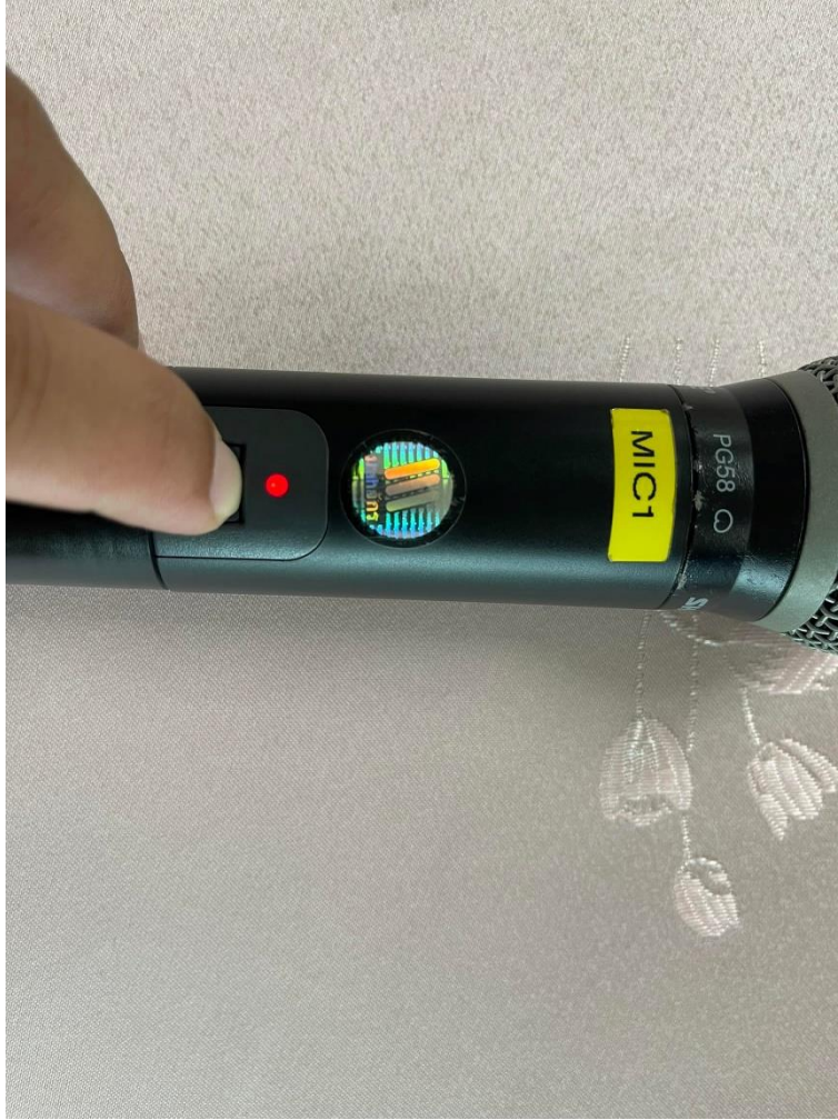
ภาพ 5 กดปุ่ม POWER ON ที่ไมโครโฟน
