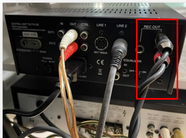
ภาพ 2 ต่อสายสัญญาณเสียง เข้าสู่ช่อง REC OUT
