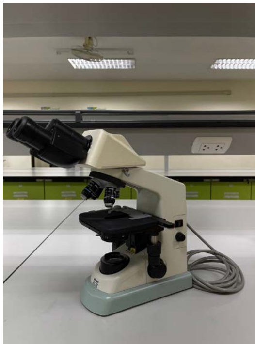
ภาพ 16 กล้องจุลทรรศน์ แบบใช้แสงเชิงซ้อน (Light Compound Microscope)
