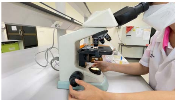
ภาพ 32 วิธีการตรวจดูเชื้อจุลินทรีย์ด้วย Oil immersion lens ของกล้องจุลทรรศน์
