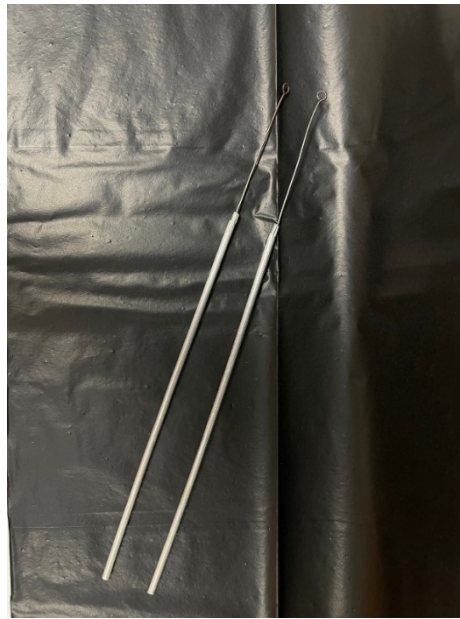
ภาพ 2 หลังกถ่ายเชื้อ/หลังกเขี่ยเชื้อ (Inoculating loop)
