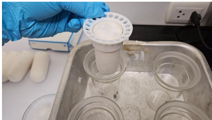
ภาพ 53 วิธีการใส่หลอดกระดาษกรองลงในขวดสกัดสาร
