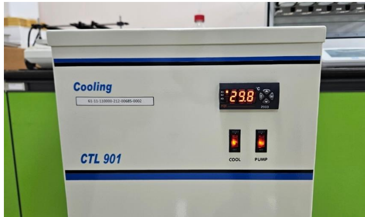
ภาพ 24 ลักษณะสวิตช์ปั๊มและคอมเพรสเซอร์กำลังทำงาน
