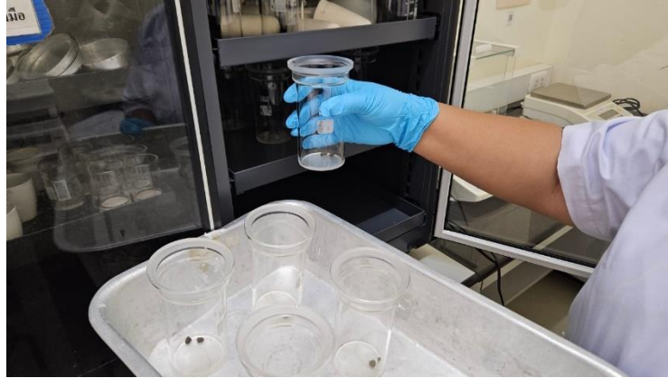
ภาพ 48 วิธีการนำขวดสกัดสารเข้าตู้ดูดความชื้น
