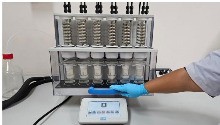
ภาพ 57 วิธีการปิดฝาด้านหน้าเครื่องสกัดไขมัน
