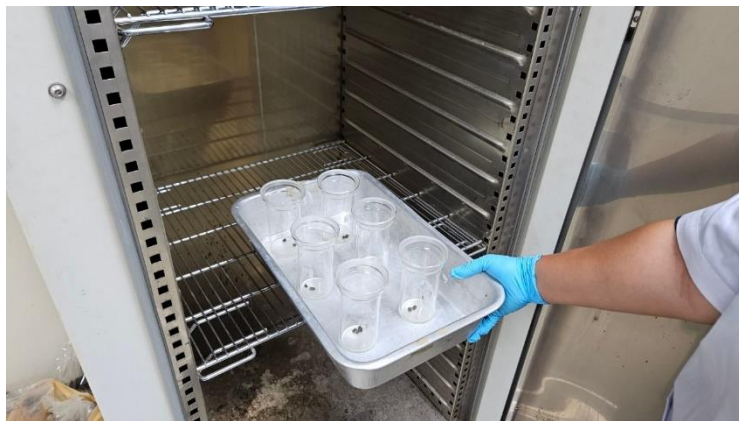
ภาพ 47 วิธีการนำเอาขวดสกัดสารเข้าตู้อบลมร้อน
