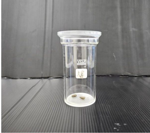
ภาพ 9 ขวดสกัดสาร + หินภูเขาไฟ (boiling stone)
