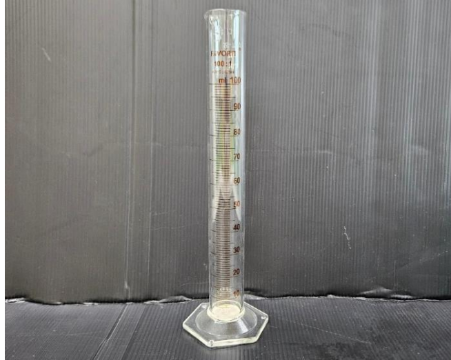
ภาพ 3 กระจกตวง (Cylinder) ขนาด 100 มิลลิลิตร
