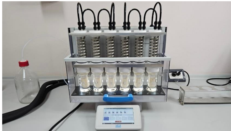
ภาพ 62 เครื่องสกัดไขมันขณะกำลังทำงาน
