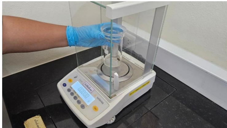
ภาพ 69 วิธีการชั่งน้ำหนักขวดสกัดสาร
