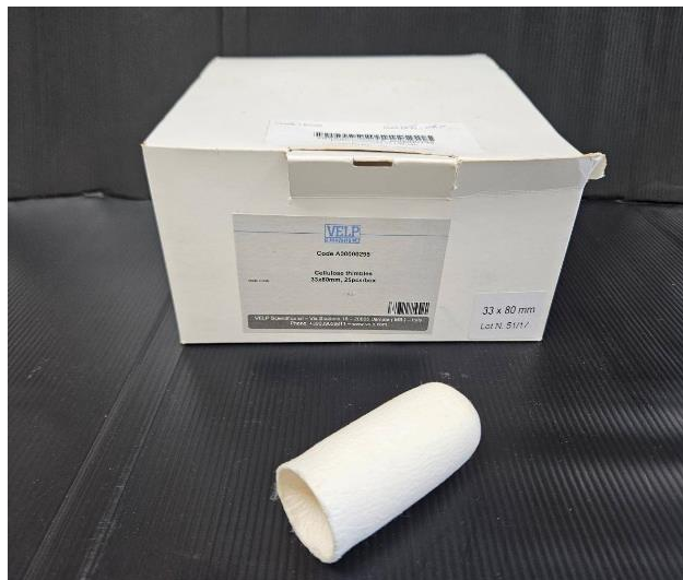
ภาพ 6 หลอดกระดาษกรอง (extraction thimble) ขนาด 33*80 mm.
