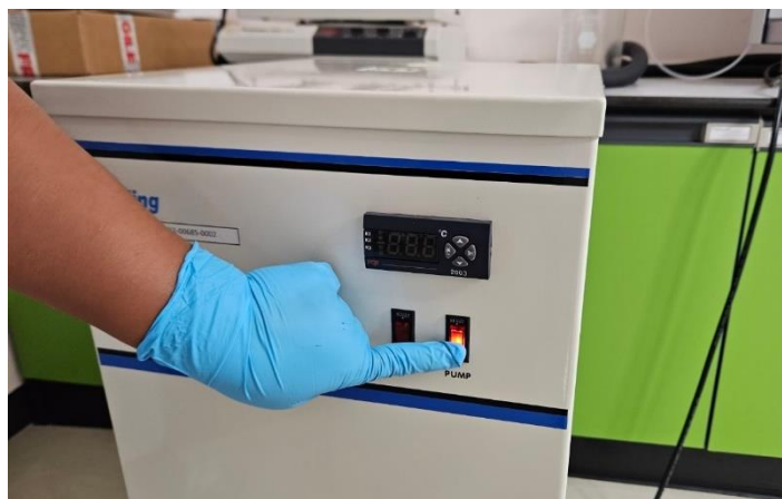
ภาพ 25 วิธีการกดสวิตช์ปิดปั๊มและคอมเพรสเซอร์
