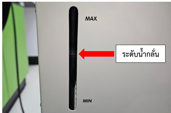
ภาพ 21 ระดับน้ำกลั่นภายในเครื่องควบคุมอุณหภูมิแบบน้ำหมุนเวียนที่เหมาะสม
