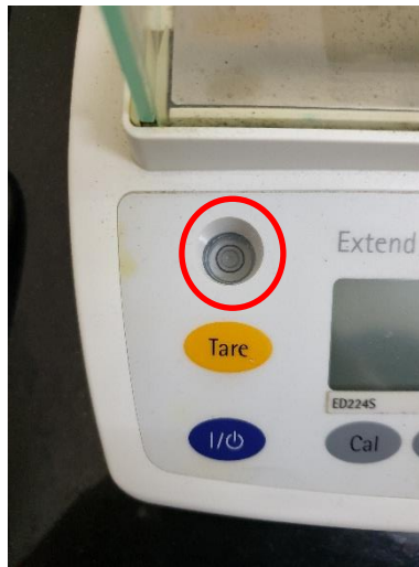
ภาพ 39 ลักษณะของลูกน้ำที่อยู่ในระดับ
