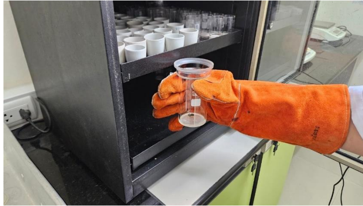
ภาพ 68 วิธีการนำขวดสกัดสารใส่ในตู้ดูดความชื้น
