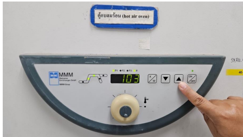
ภาพ 35 วิธีการกดปุ่มลูกศรชี้ขึ้น / ชี้ลง
