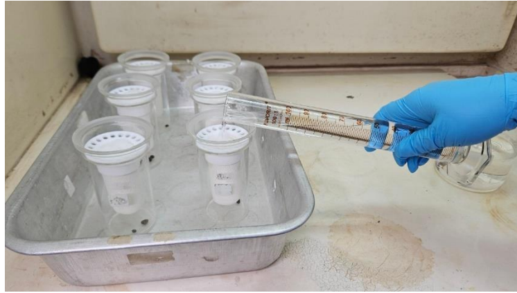
ภาพ 54 วิธีการเติสารเคมีลงในขวดสกัดสาร
