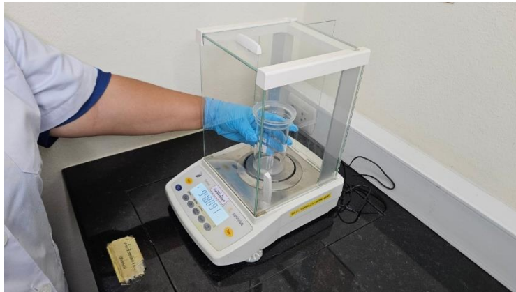
ภาพ 49 วิธีการชั่งน้ำหนักขวดสกัดสาร
