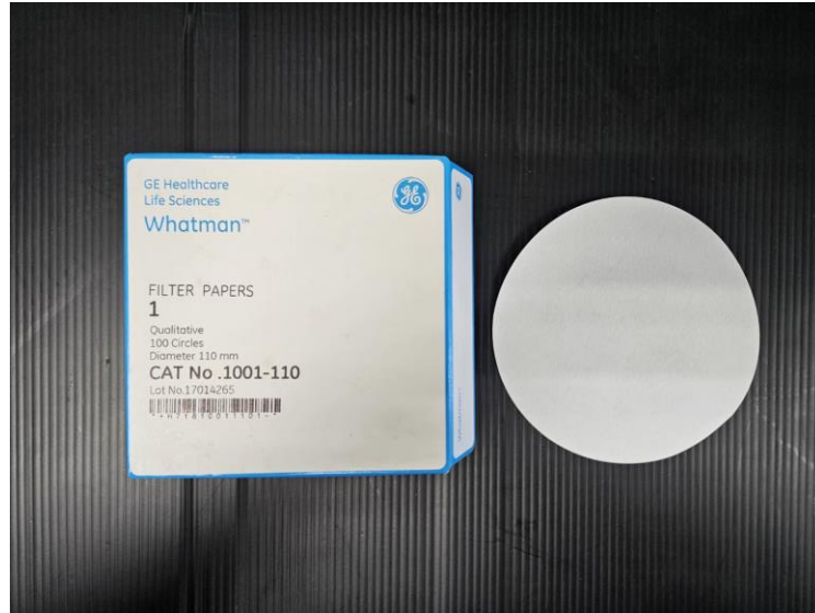
ภาพ 7 กระดาษกรอง (filter paper) เบอร์ 1 เส้นผ่านศูนย์กลาง 110 มิลลิเมตร
