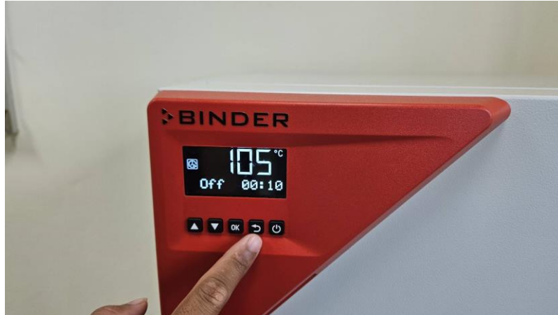
ภาพ 20 วิธีการกดปุ่มเพื่อกลับสู่หน้าจอหลัก
