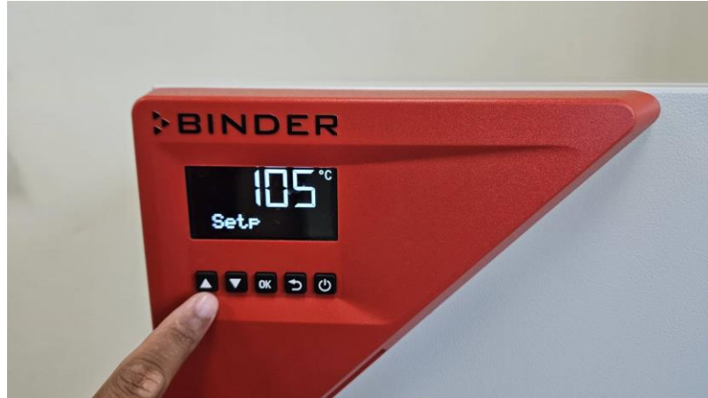
ภาพ 10 วิธีการปรับตั้งค่าอุณหภูมิตามที่ต้องการ
