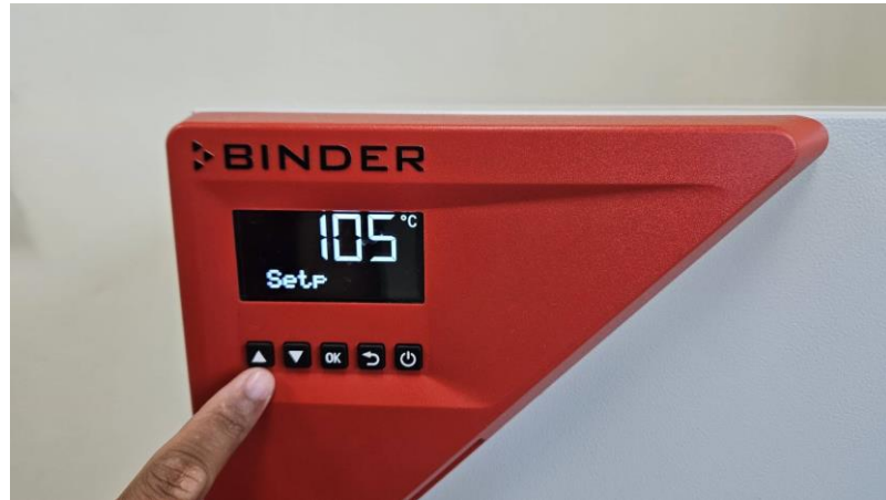
ภาพ 8 วิธีการตั้งค่าอุณหภูมิ
