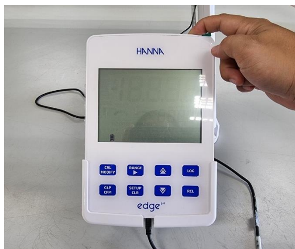
ภาพ 39 วิธีการเปิดเครื่องวัดค่าความเป็นกรดต่าง
