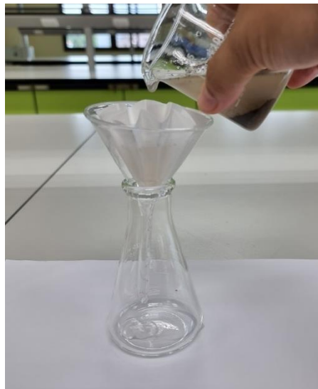
ภาพ 36 วิธีการกรองสารละลายตัวอย่างดิน
