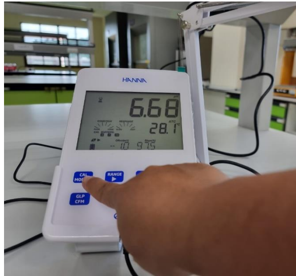
ภาพ 42 วิธีการกดปุ่ม CAL เพื่อทำการสอบเทียบ
