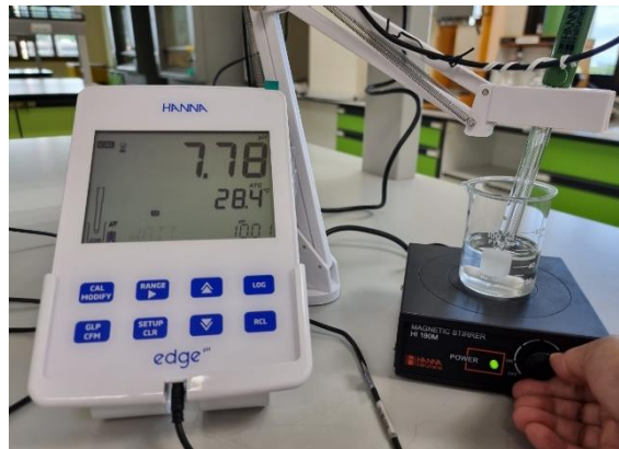
ภาพ 51 วิธีการสอบเทียบค่าความเป็นกรดต่าง ที่ pH 10
