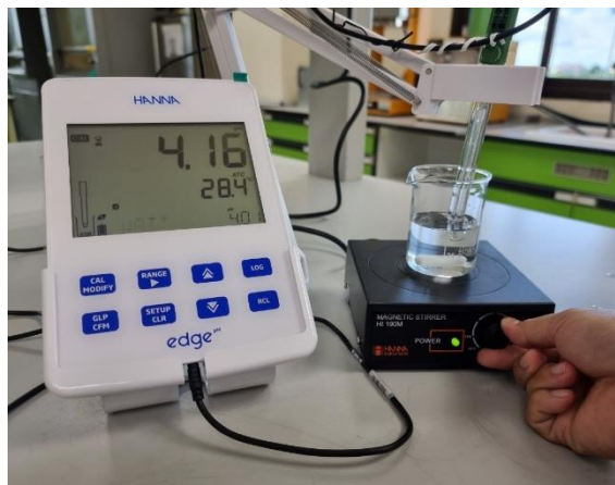
ภาพ 47 วิธีการสอบเทียบค่าความเป็นกรดต่าง ที่ pH 4
