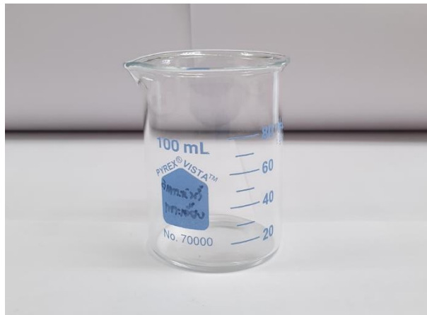
ภาพ 1 ปีกเกอร์ (Beaker) ขนาด 100 มิลลิลิตร
