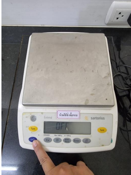
ภาพ 25 วิธีการกดปุ่มสีน้ำเงินเพื่อทำการเปิดเครื่องชั่ง
