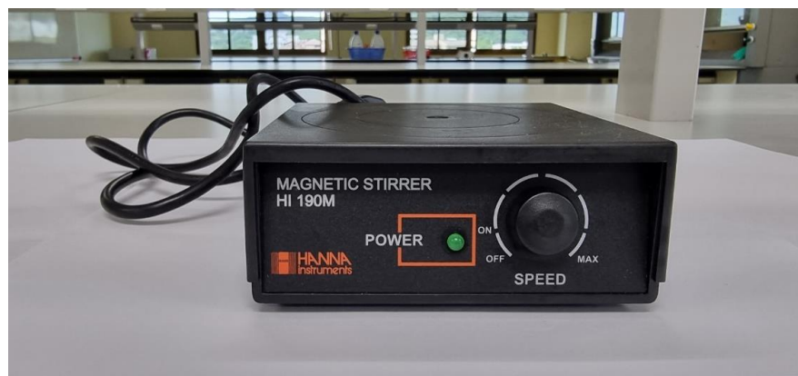
ภาพ 21 เครื่องคนสารละลาย (Magnetic stirrer) รุ่น HI190M ยี่ห้อ Hanna
