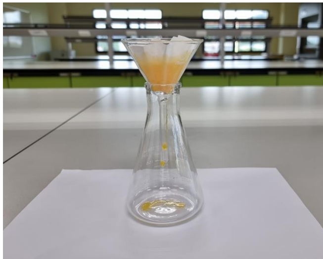
ภาพ 22 วิธีการกรองสารละลายตัวอย่างน้ำผลไม้
