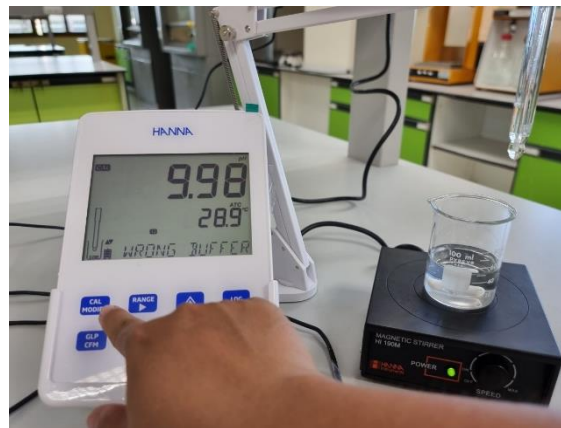
ภาพ 53 วิธีการบันทึกผลการสอบเทียบและออกจากหน้าจอหลัก
