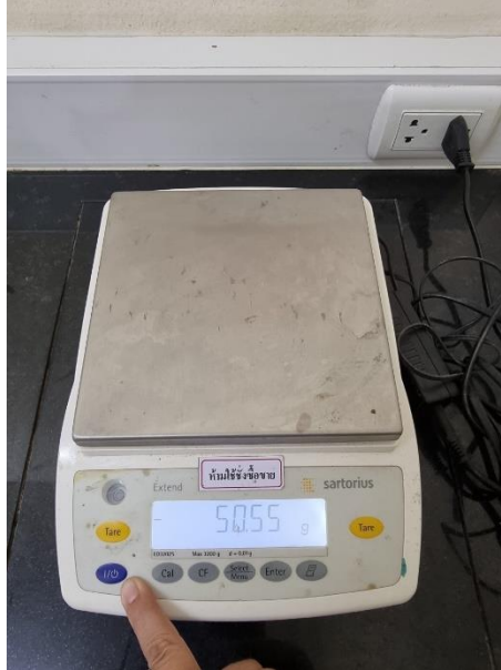
ภาพ 31 วิธีการกดปุ่มสีน้ำเงินเพื่อทำการปิดเครื่องชั่ง
