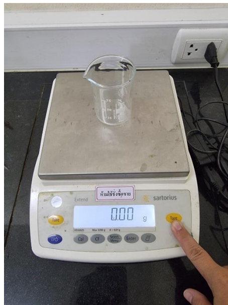
ภาพ 17 วิธีการกดปุ่ม Tare น้ำหนักเครื่องชั่ง
