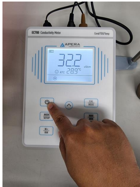
ภาพ 42 วิธีการปิดเครื่องวัดค่าการนำไฟฟ้า
