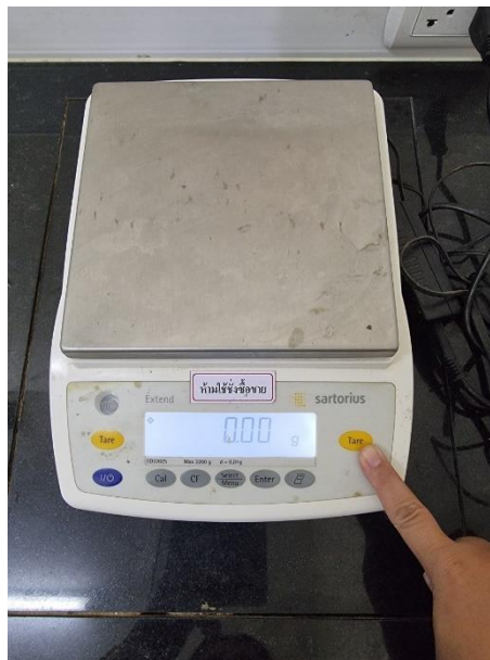
ภาพ 15 วิธีการกดปุ่ม Tare น้ำหนักเครื่องชั่ง
