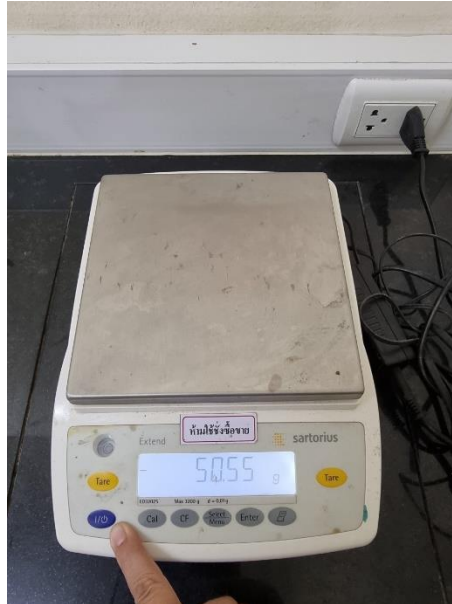
ภาพ 20 วิธีการกดปุ่มสีน้ำเงินเพื่อทำการปิดเครื่องชั่ง
