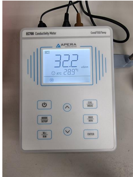
ภาพ 39 หน้าจอแสดงผลค่าการนำไฟฟ้าและค่าอุณหภูมิ
