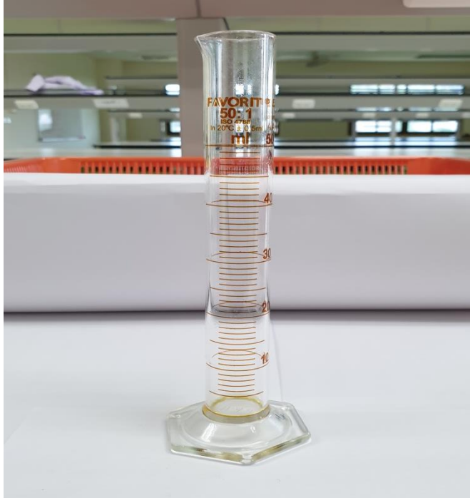
ภาพ 4 กระจกบอกลิตร (Cylinder) ขนาด 50 มิลลิลิตร
