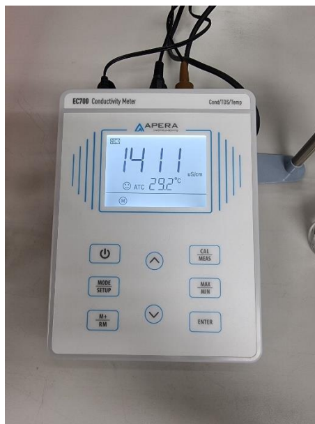
ภาพ 33 หน้าจอแสดงโหมดการวัดค่าการนำไฟฟ้า
