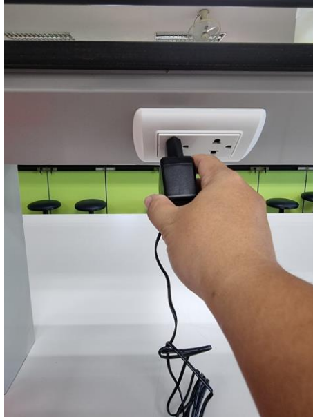
ภาพ 43 วิธีการถอดปลั๊กเครื่องวัดค่าการนำไฟฟ้า
