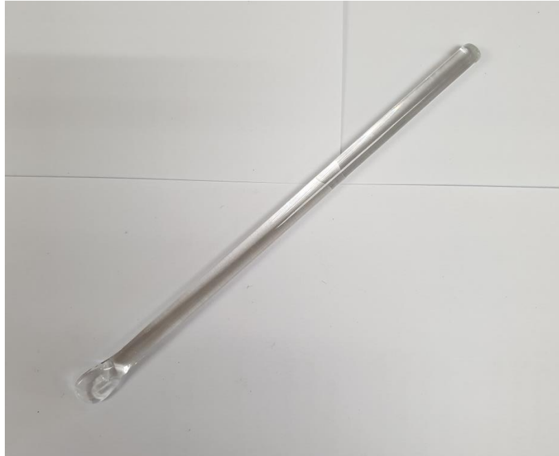
ภาพ 6 แท่งแก้วคน (Stirring rod) ขนาดความยาว 6 นิ้ว
