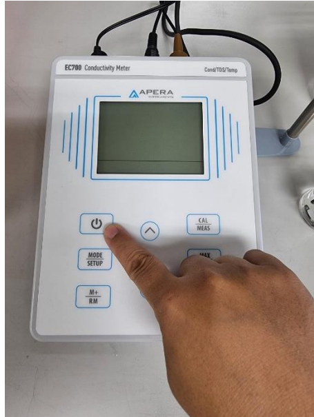
ภาพ 26 วิธีการกดเปิดเครื่องวัดค่าการนำไฟฟ้า
