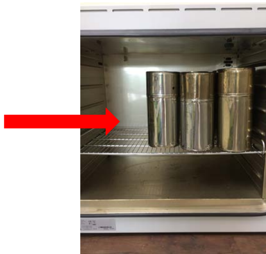
ภาพ 6 การนำอุปกรณ์เครื่องแก้ว เข้าตู้อบลมร้อน
