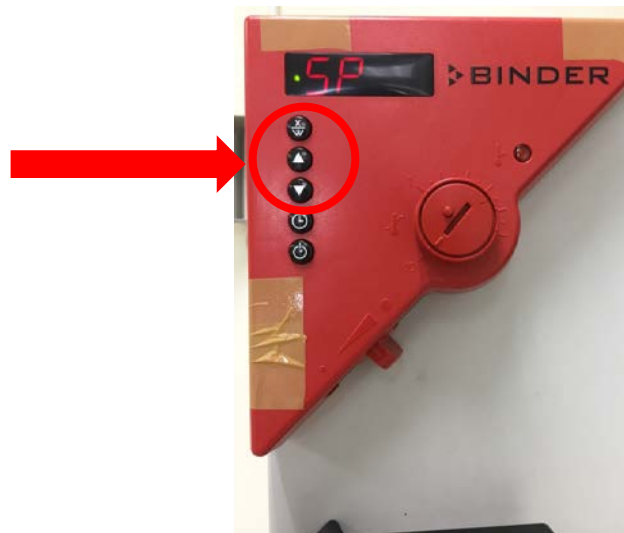
ภาพ 4 การตั้งค่าอุณหภูมิ
