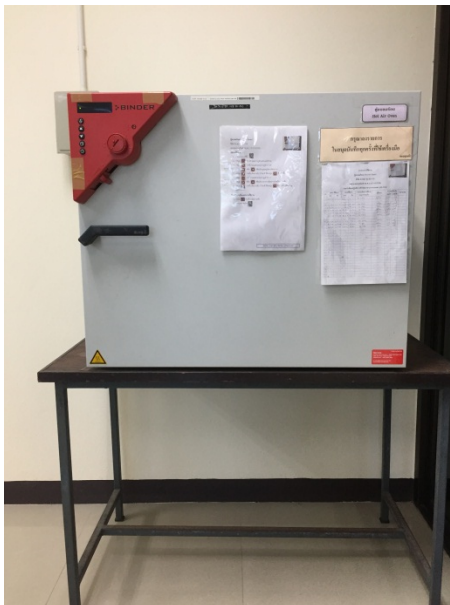
ภาพ 1 ตู้อบลมร้อน (Hot air oven) ยี่ห้อ Binder รุ่น ED 115
