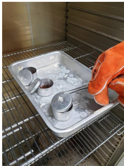
ภาพที่ ๔๙. แสดงวิธีการเปิดฝากระป๋องอลูมิเนียมภายในตู้อบลมร้อน
