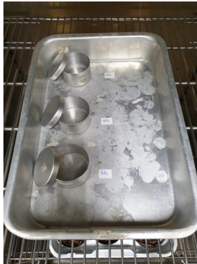
ภาพที่ ๓๖. แสดงลักษณะการวางกระป๋องอลูมิเนียมขณะเปิดฝาในตู้อบลมร้อน
