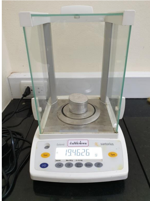
ภาพที่ ๔๘. ลักษณะของหน้าจอแสดงผลเมื่อทำการชั่งน้ำหนักตัวอย่างพร้อมกระป๋องอลูมิเนียมขณะปิดฝา
