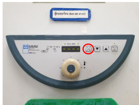
ภาพที่ ๑๖. แสดงสถานะของตู้อบลมร้อนหลังจากที่กดปุ่ม x/w
