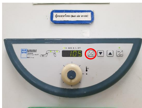
ภาพที่ ๑๘. แสดงอุณหภูมิที่ได้ตั้งไว้
