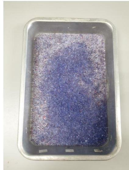
ภาพที่ ๓๐. ลักษณะของซิลิกาเจลที่สามารถดูดความชื้นได้ ภาพที่ ๓๑. ลักษณะของซิลิกาเจลที่ไม่สามารถดูดความชื้นได้
