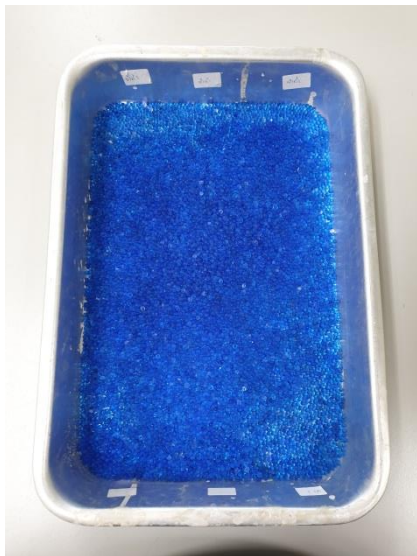
ภาพที่ ๓๐. ลักษณะของซิลิกาเจลที่สามารถดูดความชื้นได้ ภาพที่ ๓๑. ลักษณะของซิลิกาเจลที่ไม่สามารถดูดความชื้นได้
