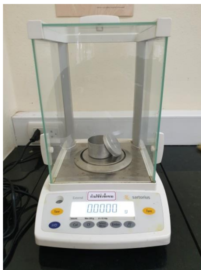
ภาพที่ ๔๒. ลักษณะของหน้าจอแสดงผลเมื่อทำการ Tare น้ำหนักกระป๋องอลูมิเนียมขณะเปิดฝา
