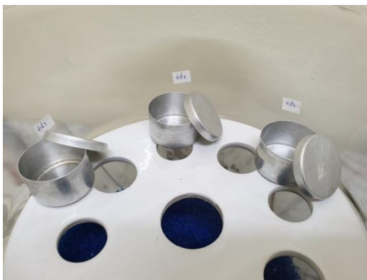
ภาพที่ ๔๐. แสดงลักษณะการวางกระป๋องอลูมิเนียมขณะเปิดฝาในโถดูดความชื้น
