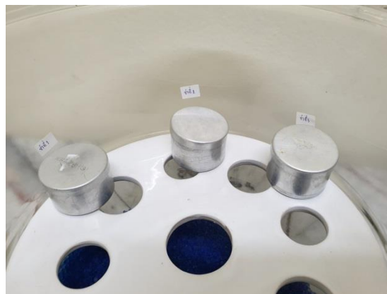
ภาพที่ ๕๑. แสดงลักษณะการวางกระป๋องอลูมิเนียมขณะปิดฝภายในโถดูดความชื้น
