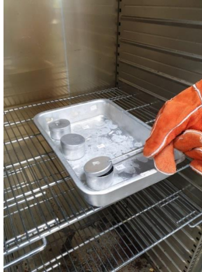
ภาพที่ ๕๐. แสดงวิธีการปิดฝากระป๋องอลูมิเนียมภายในตู้อบลมร้อน
