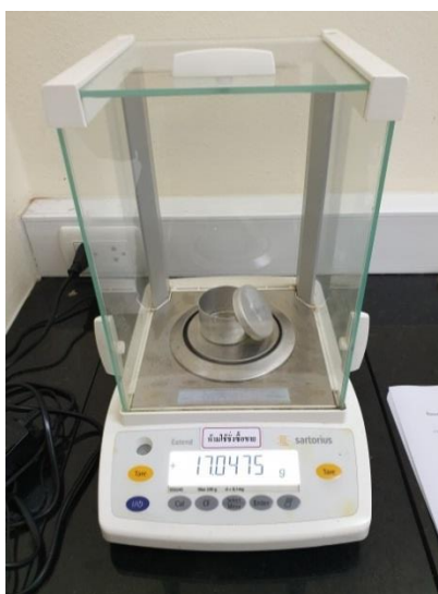
ภาพที่ ๔๑. แสดงลักษณะการวางกระป๋องอลูมิเนียมขณะเปิดฝานบนจานชั่ง
