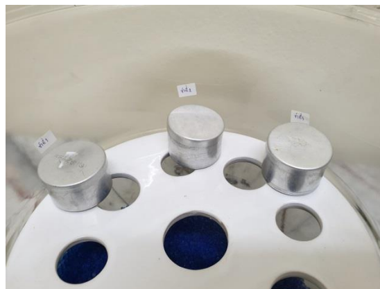
ภาพที่ ๔๗. แสดงลักษณะการวางกระป๋องอลูมิเนียมขณะปิดฝภายในโถดูดความชื้น
