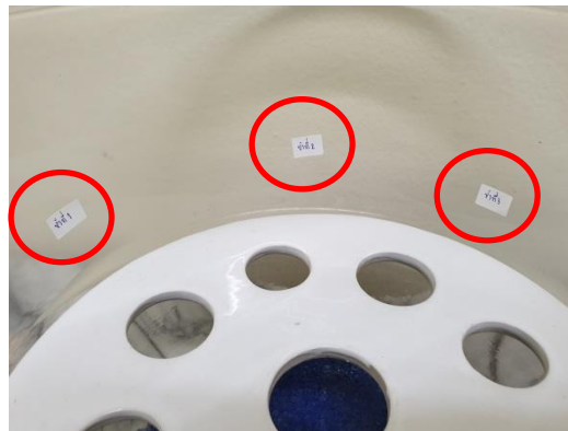
ภาพที่ ๓๕. แสดงวิธีการติดกระดาษเลเบลในโถดูดความชื้น
