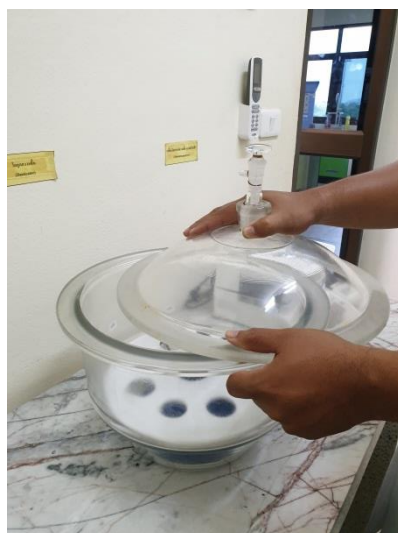
ภาพที่ ๓๓. แสดงวิธีการเปิดปิดโถดูดความชื้น
