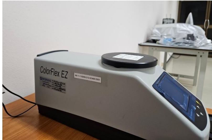
ภาพ 32 วิธีการวางแผ่นสีมาตรฐานสีขาวที่เครื่องวัดค่าสี
