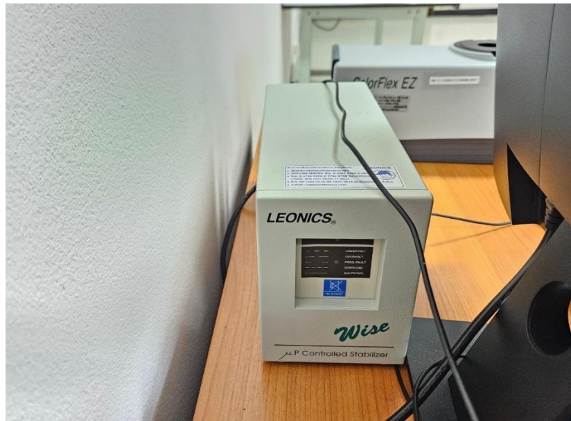
ภาพ 12 เครื่องปรับแรงดันไฟฟ้าอัตโนมัติ Stabilizer ขนาด 500VA รุ่น wise-500i ยี่ห้อ Leonics
