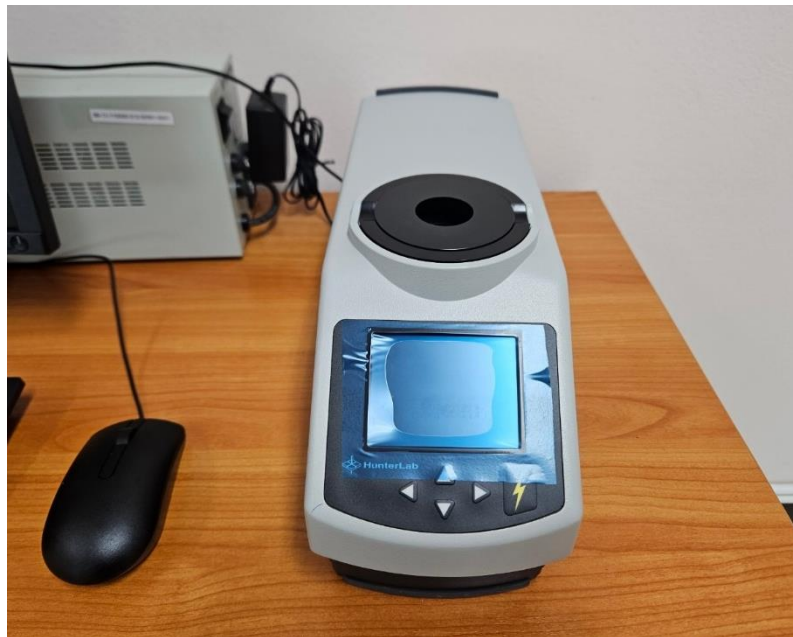
ภาพ 10 เครื่องวัดค่าสี รุ่น color flex EZ ยี่ห้อ Hunter Lab
