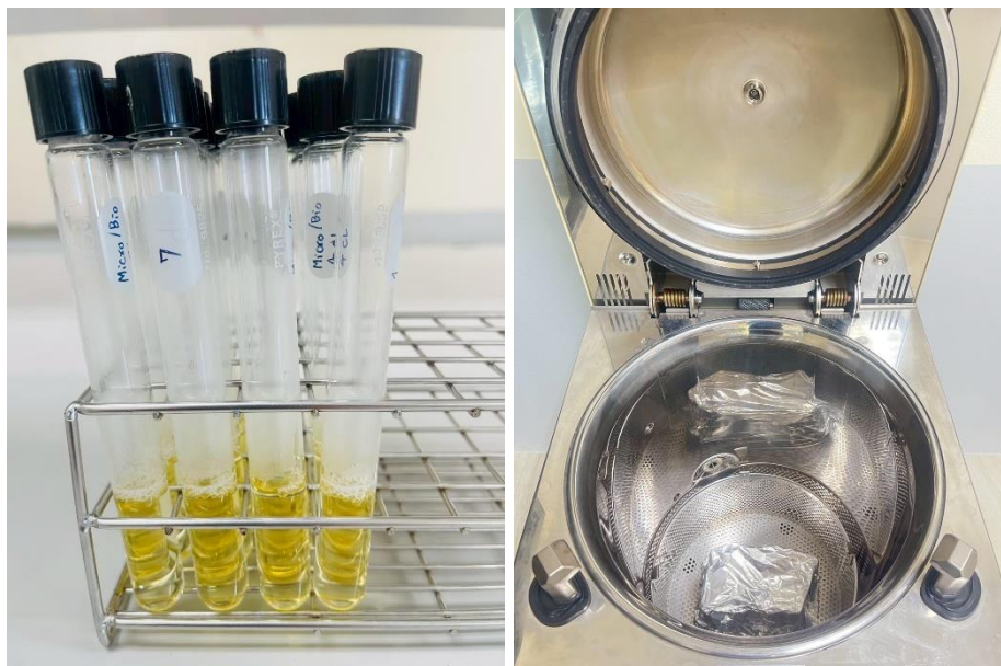
ภาพ 28 วิธีการเตรียมอาหารเลี้ยงเชื้อ Potato Dextrose Agar; PDA ก่อนนำไปฆ่าเชื้อ
