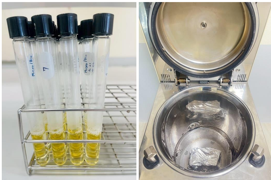
ภาพ 20 วิธีการเตรียมอาหารเลี้ยงเชื้อ Nutrient Agar; NA ก่อนนำไปฆ่าเชื้อ
