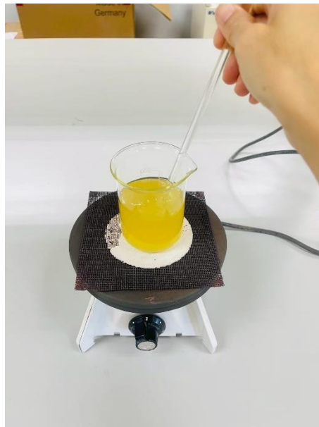
ภาพ 26 วิธีการละลายอาหารเลี้ยงเชื้อ Potato Dextrose Agar; PDA บนเตาต้มร้อน
