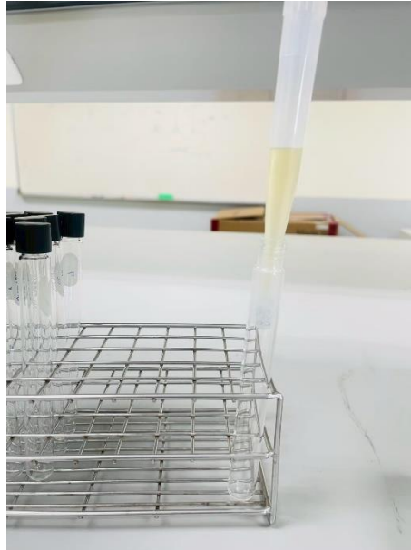
ภาพ 27 วิธีการดูดอาหารเลี้ยงเชื้อ Potato Dextrose Agar; PDA ใส่หลอดทดลอง
