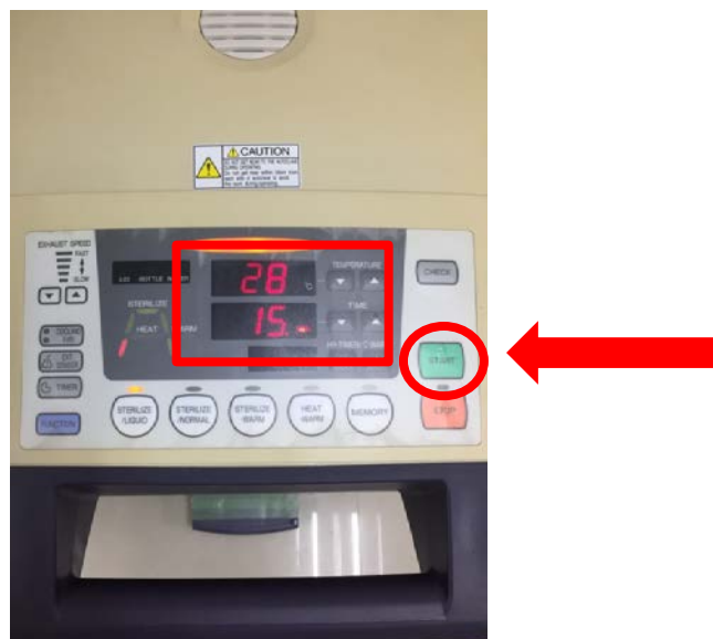
ภาพ 54 หม้อนึ่งฆ่าเชื้อเมื่อกดปุ่ม START
