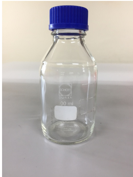
ภาพ 1 ขวดเตรียมอาหารเลี้ยงเชื้อ (Duran bottle)
