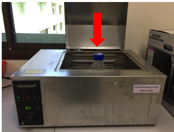
ภาพ 111 การนำขวดอาหารเลี้ยงเชื้อไปลดอุณหภูมิในอ่างน้ำควบคุมอุณหภูมิ
