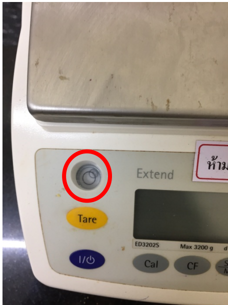
ภาพ 14 ลักษณะของลูกน้ำที่ไม่ได้อยู่ในระดับ
