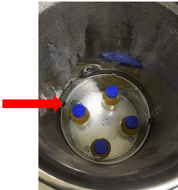
ภาพ 50 การนำอาหารเลี้ยงเชื้อลงในหม้อนึ่งฆ่าเชื้อ
