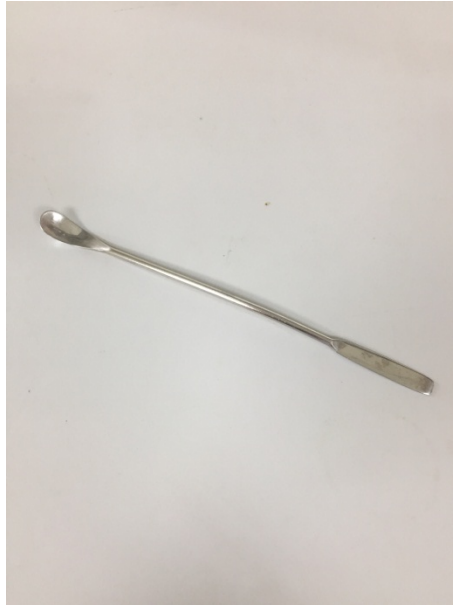
ภาพ 2 ช้อนตักสารสแตนเลส (Stainless spatula)
