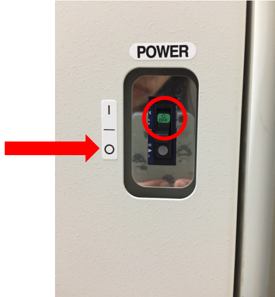
ภาพ 58 การกดปุ่ม POWER ด้านข้างเครื่องไปที่ “O”
